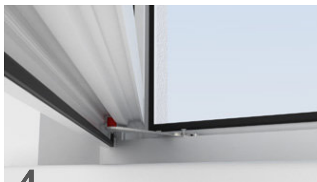
2 Vložte magnetickou pojistku do rámu okna ve vzdálenosti cca 60 mm od vnitřní strany rámu a to vždy na pantové straně křídla
